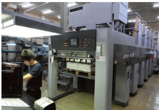
写真は排紙側だが、給紙にロールフィダー(ロール to シーター)を設置。輪転機用の紙も併用でき、枚葉機は仕事の9割以上は巻取紙を使っている
